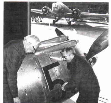
Martin Bengtsson t v och Harry Frohm kontrollerar om det finns korrosion i mu-seets J9-a. I bakgrunden B3-an med sina av solljuset alltmer mjölkvita huvglas.
