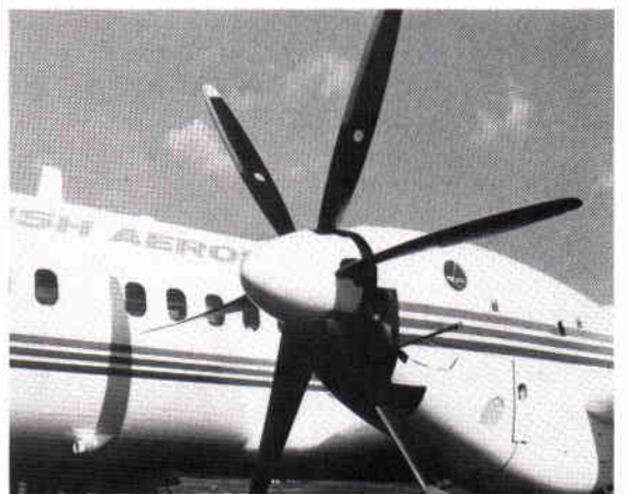
Den sexbladiga propellern på ATP vilken är tillverkad av kompositmaterial.
