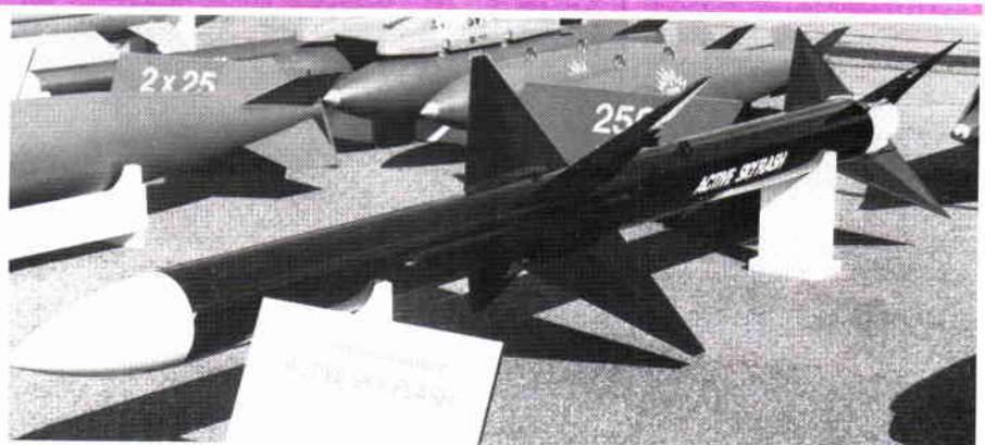
Fullskalemodell av en framtida utveckling av Sky Flash med aktiv målsökare.
