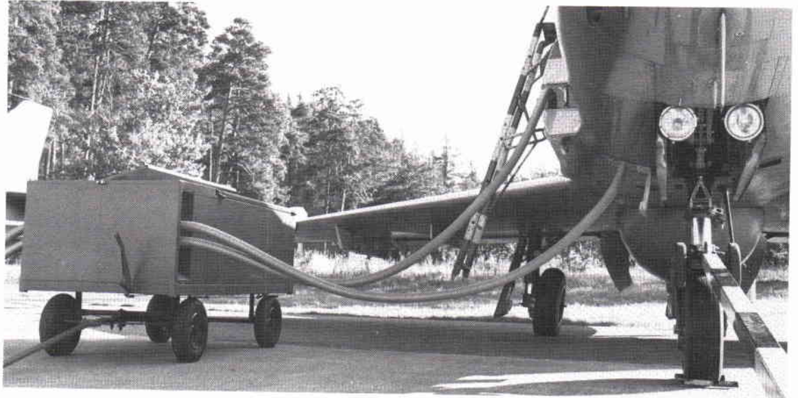
Bild 3. Avfuktning utomhus av Fpl 32 vid F13M.
